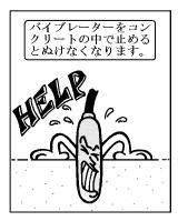
○ 振動部で鉄筋や型枠などをこじらないでください。 振動部が摩耗しモータが焼損する恐れがあります。
