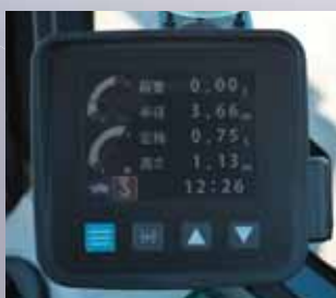
ハイリーチクレーン仕様の定格荷重表示例
