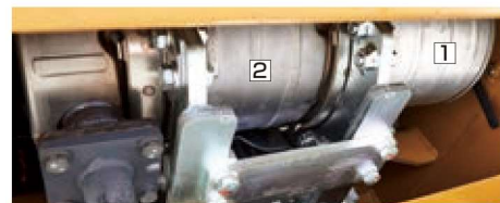
① DOC: ディーゼル酸化触媒 ② DPF: ディーゼルパーティキュレートフィルタ
