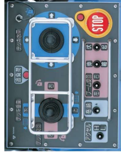
デッキ内部操作パネル
