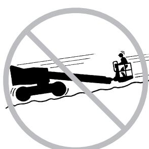
地面の状態、まわりの混雑具合、傾斜、人の位置、およびその他追突の要因となるものによって、走行速度を制限してください。
