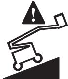
機械が水平でない場合にランプが点灯します。このランプが点灯している間、傾斜アラームが鳴ります。機械を安定した平坦な地面に移動してください。
