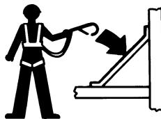
作業員は安全ベルトやハーネスを着用し、適合する法規に従わなければなりません。安全帯を作業台の錨に取り付けてください。
