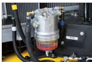
ウォーターセパレータ機能付燃料プレフィルタ
