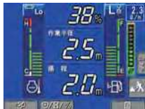
作業半径・揚程・負荷率表示
