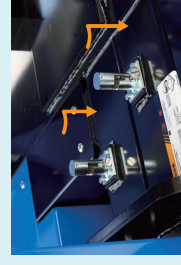
ロックピンをかけることで走行作業中のアウトリガー飛び出しを防止します。
