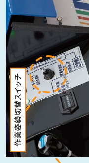
誤操作防止のため、走行作業を行う際にはスイッチによるモード切替が必要です。
