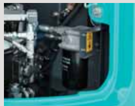
交換時にオイルが垂れにくい縦置 きエンジンオイルフィルタ
