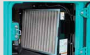
左後方ガード：iNDrフィルタ/ バッテリー/冷却機器/ラジエータ冷却 水/他
