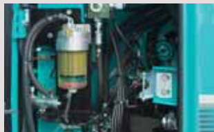
右サイドガード：コントロールバルブ/ マルチコントロール/燃料フィルタ/他
