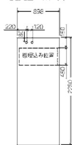
④配電盤パネル (E)
