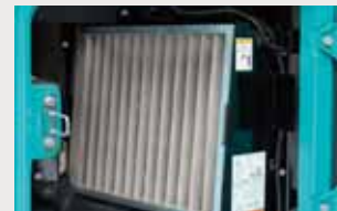
左後方ガード：iNDrフィルタ/バッテリ/ 冷却機器/ラジエータ冷却水/ 他
