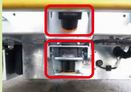
ライトレールセンサ(上)、追従感知センサ(下)
