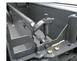
※施工中でも上下調整が可能
