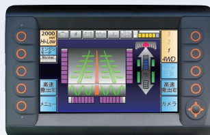
スクリュ・コンベヤ搬送状態
