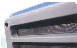
ラジエータグリルに防塵ネットを装着。ラジエータの目詰まりを防ぎます。
