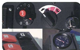
エンジンスロットルはダイヤル式を採用。大型タコメータを見やすい前方に配置しました。防水性の高いスイッチ類を採用し、信頼性の向上を図りました。
