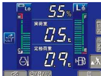
実荷重・定格荷重・負荷率表示
