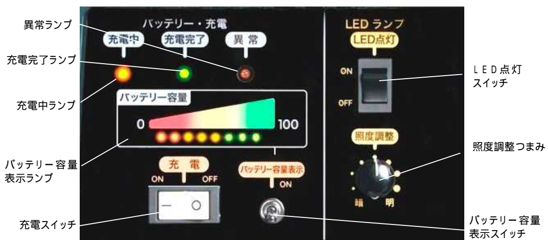
バッテリー発電機 S B G 1 5 コントロールパネル
