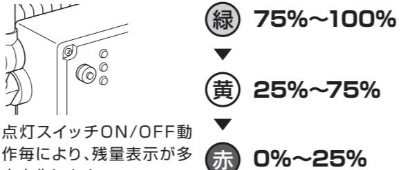
点灯スイッチON/OFF動作毎により、残量表示が多少変化します。
