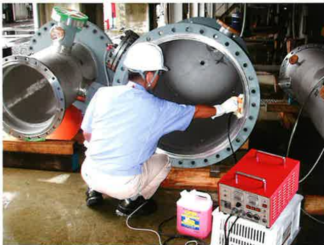
コテ型電極による不動態化処理風景
