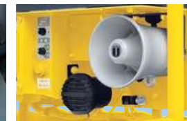
デッキ側インターホン
