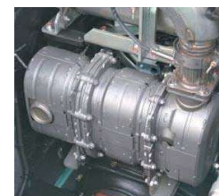
排ガス後処理装置
