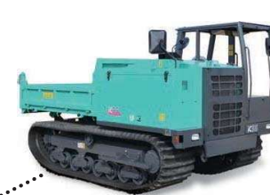
メンテナンスが多い部品を右側に集約しています。
