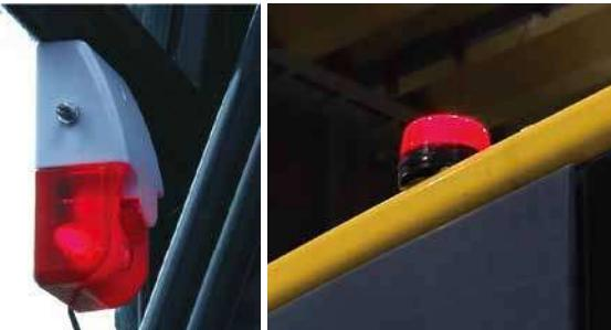
警報装置は運転席とキャビン上部の2カ所に設置。オペレーターにはもちろん、周りの作業員にもしっかり警告し、安全性を確保します。
