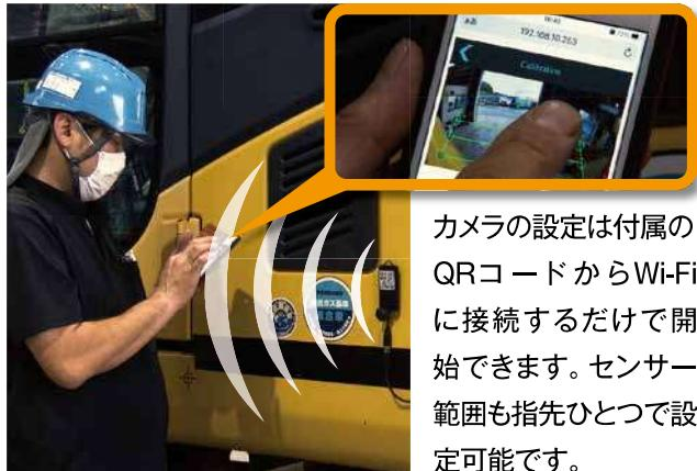
カメラの設定は付属のQRコードからWi-Fiに接続するだけで開始できます。センサー範囲も指先ひとつで設定可能です。
