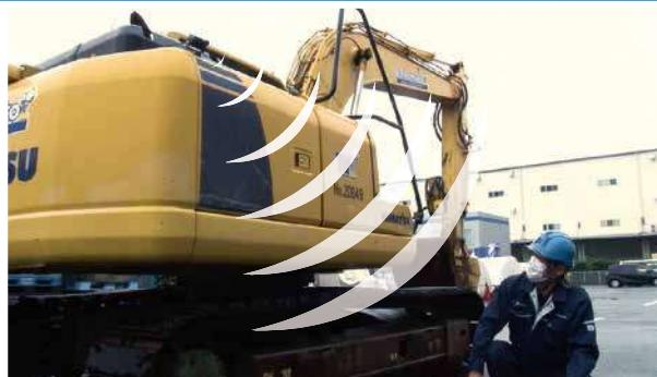
現場作業員に気づかずバック、あるいは旋回した場合でも正確に検知して警告。接触事故を未然に防ぎます。
