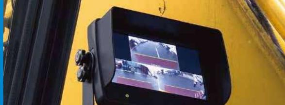
カメラからの映像は、運転席に設置したモニターに3分割表示。センサー範囲内に物体を検知すると、「人」と「物」を分けて表示します。
