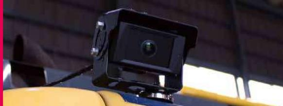
オペレーターの死角になる建機の後方3カ所に、AIを活用した特殊カメラを設置。対象との距離を認識し、正確な空間把握を実現します。
