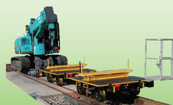
貫通ブレーキ仕様 回転台座により長尺物運搬が可能
