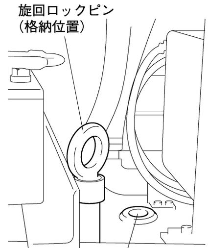
旋回ロックピン差し込み穴
