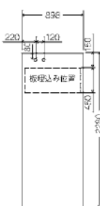
④配電盤パネル (E)
