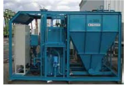
処理前SS : 2,800mg/L ・ pH11.8 → 処理後SS : 20mg/L ・ pH7.3
