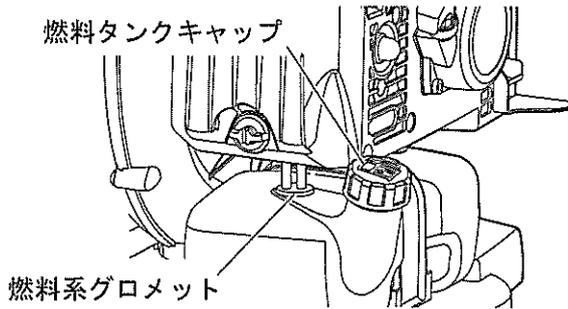
1. 燃料を補給した後、燃料タンクキャップを確実に締め付け、燃料パイプ、燃料系グロメット、燃料タンクキャップ周辺から燃料の漏れ、にじみがないことを確認してください。
