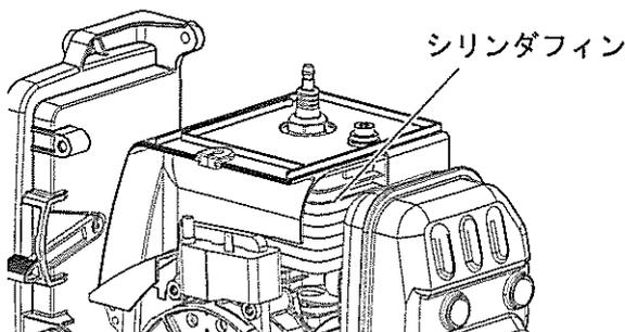
1. エンジンカバーのスクリュ（10個）を外し、エンジンからエンジンカバーを取り外してください。
