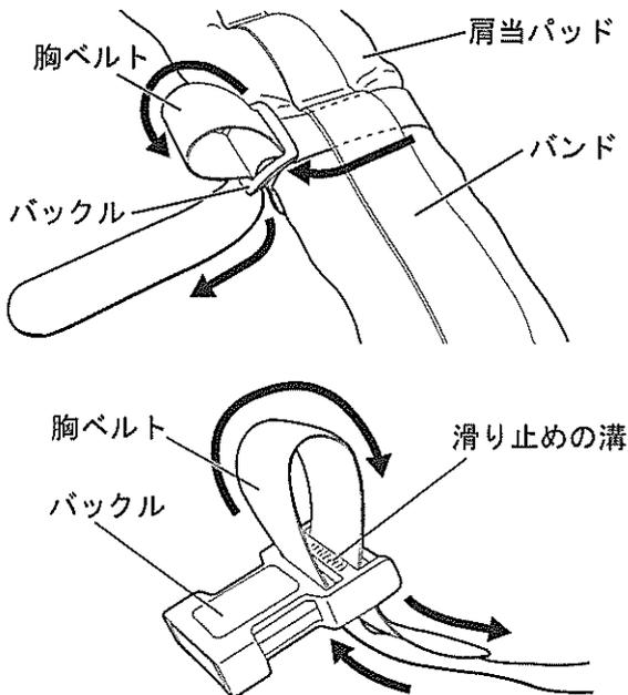
胸ベルトを使用することにより、背負いバンドが左右にずれにくくなります。使用状況に合わせて胸ベルトを取り付けてください。
