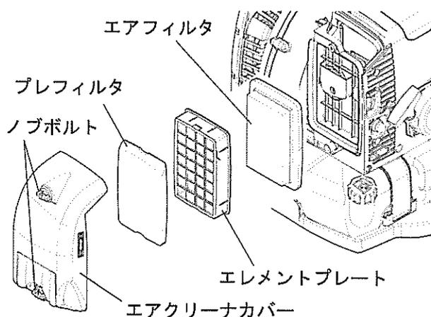
1. チョークレバーを「閉」(閉)の位置にしてから、ノブボルト2本をゆるめ、エアクリーナカバー、プレフィルタ、エレメントプレート、エアフィルタを取り外してください。
