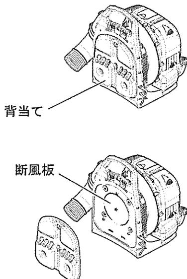
この製品の背当てでは、温暖時に使用する際に背中が蒸れるのを防止する冷却機能を装備しています。このため、寒冷時に使用する際に背中が寒く感じる場合がありますので、その場合は付属している断風板を取り付けてください。
