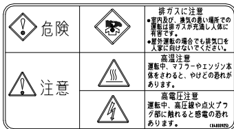
①排ガス・高温・高電圧
