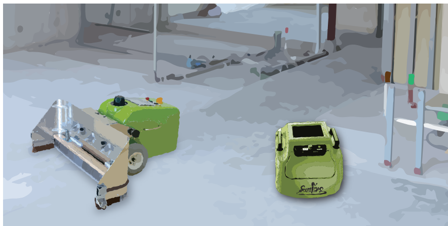
※自律型清掃ロボットとのコラボにより清掃→墨出しの自動化を実現!
