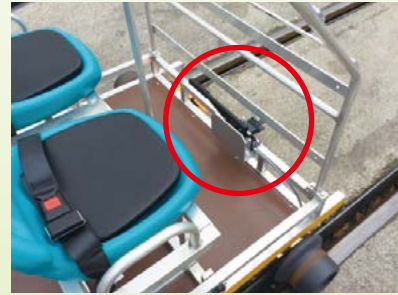
駐車 ブレーキ
