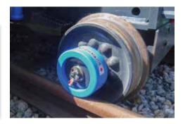
カバーなしだと <mark>短縮・</mark> <mark>クラッチ 破損</mark>の 恐れあり!
